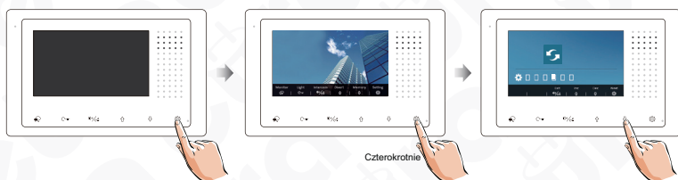
Rys. 11. Przywracanie do ustawień domyślnych
