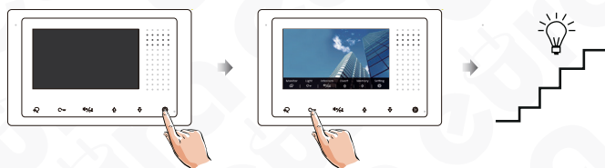
Rys. 13. Włączanie/ wyłączenie oświetlenia
