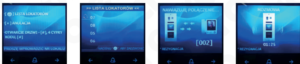
Rys. 25. Wywołanie lokatora z modułu wyświetlacza LCD VXA-65A5
