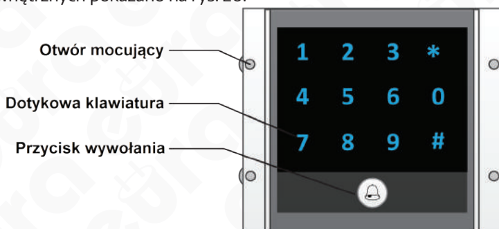
Rys. 20. Zewnętrzna budowa modułu klawiatury szyfratora VXA-64A5
