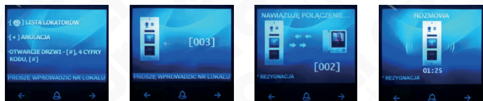
Rys. 26. Wywołanie lokatora z modułu klawiatury VXA-64A5
